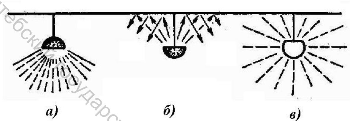
Рисунок 4.2 – Распределение светового потока в светильниках: а – прямой и преимущественно прямой; б – отраженный и преимущественно отраженный; в – рассеянный
