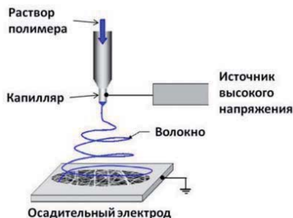
Рисунок 2 – Получение нановолокнистых материалов электроформованием
