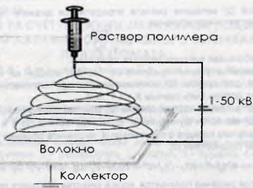
Рисунок 1 – Схема получения наноразмерных волокон электроформованием
