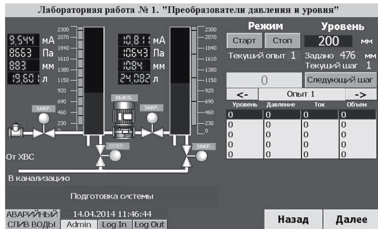
Рисунок 3 – Интерфейс лабораторной HMI панели
