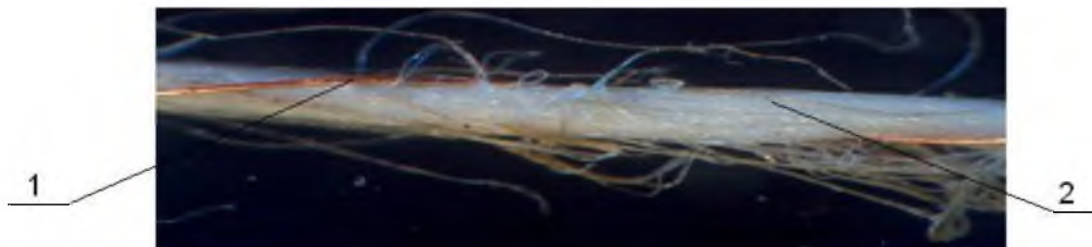
Рисунок 3 – Комбинированная льносодержащая электропроводящая нить линейной плотности 47 текс под микроскопом:
