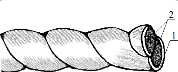
Рисунок 1 – Структура армированной швейной нитки: 1 – оплетка, 2 – сердечник
