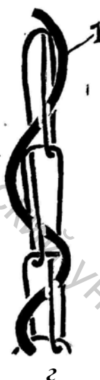
Рисунок 4.97 – Строение трикотажа уточных переплетений с каркасными уточными нитями: a – ластик 1+1 с поперечными уточными нитями, проложенными на всю ширину, б – основовязаный одинарный с продольными уточными нитями, проложенными в 3-х петельных столбиках, в – кулирная гладь с продольными и поперечными нитями на всю ширину, г – одинарная основовязаная цепочка с продольной уточной нитью, проложенной в одном петельном столбике
