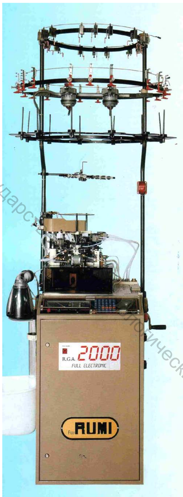
Рисунок 5.4 – Общий вид одноцилиндрового круглочулочного автомата
