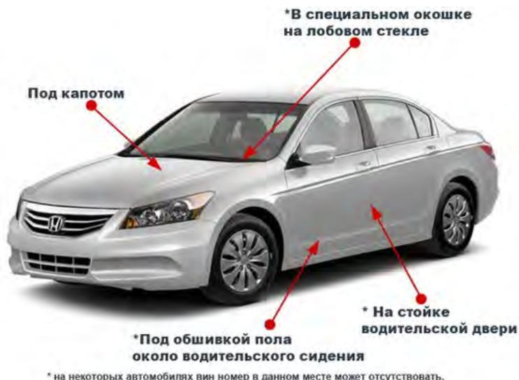
Рисунок 1 – Расположение Vin-кодов на транспортном средстве
