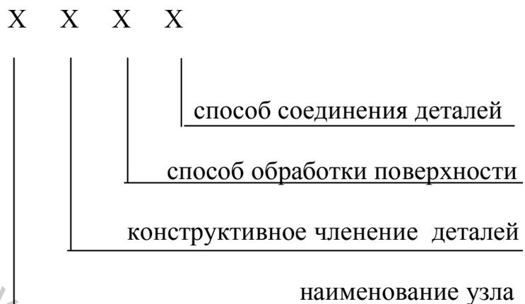
Рисунок 1.2 – Структурная схема кодирования узлов
