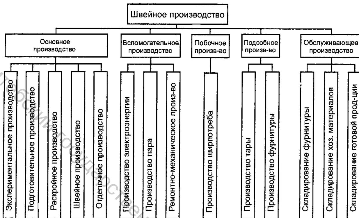
Рисунок 1.1 – Схема производственной структуры швейного предприятия
