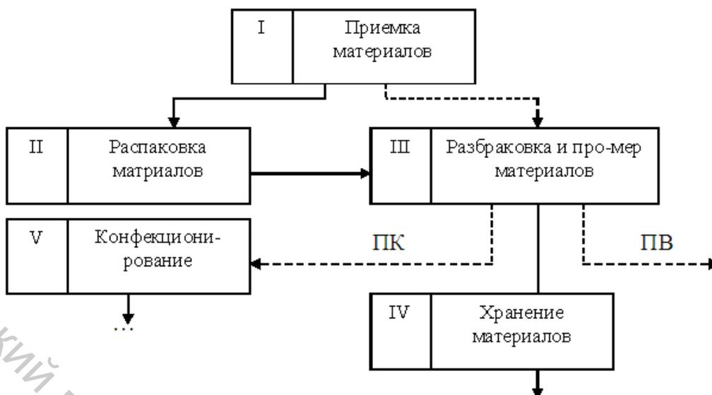
Рисунок 4.1 – Блок-схема работ, выполняемых в подготовительном цехе (фрагмент)
