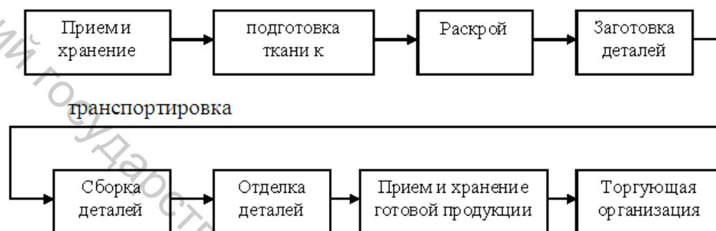
Рисунок 2.1 – Схема производственного процесса
