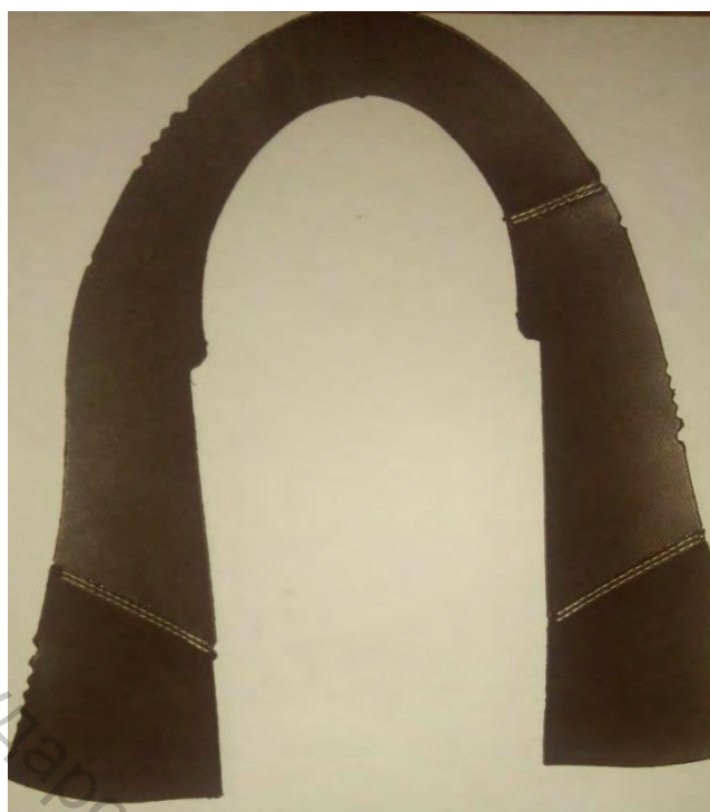
Рисунок 3 – Заготовка, собранная на полуавтомате ПШ-1
