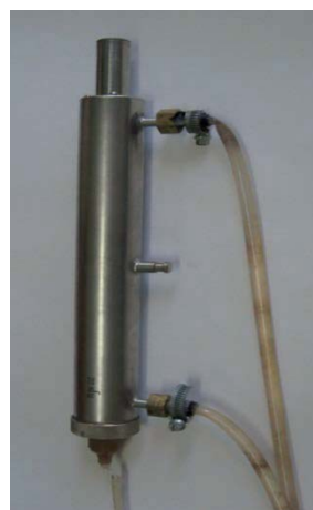
Рисунок 2– Схема механоактивации порошковых материалов подводом УЗК снизу (а), вид акустического узла (б): 1– кювета с порошком; 2– жидкость; 3 – обрабатываемый порошок; 4 - магнестрикционный преобразователь.
