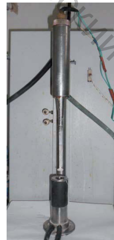
Рисунок 1 – Схема ультразвуковой механоактивации порошковых материалов с помощью погружного волновода (5), (а) и вид экспериментальной установки (б): 1– кювета с порошком; 2– жидкость; 3 – обрабатываемый порошок; 4 – охлаждающие патрубки; 5- концентратор; 6 - магнитострикционный преобразователь.
