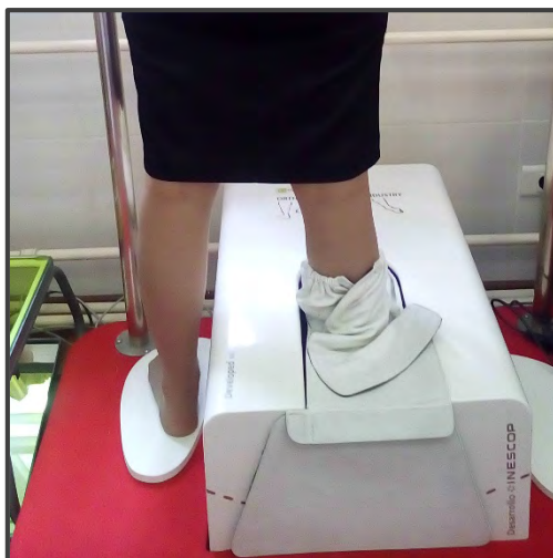
Рисунок 2 – Процесс сканирования на стационарном ортопедическом сканере Inescop
