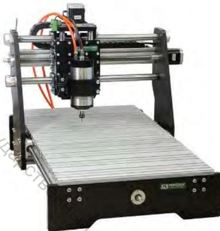
Рисунок 10.4 – Конструкция станка с ЧПУ
