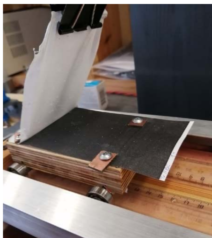
Рисунок 4.3 – Процесс снятия нановолокнистого материала с подложки
