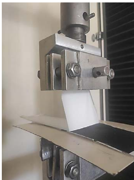
Рисунок 4.7 – Заправка разрывной машины при определении силы сопротивления отслаиванию нановолокнистых покрытий от подложки
