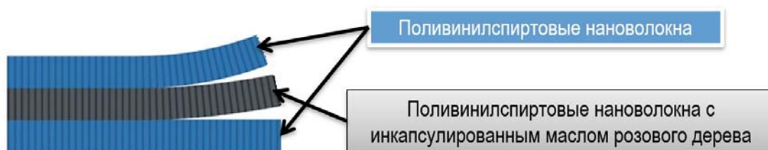
Рисунок 5.7 – Структура трехслойного нановолокнистого материала
