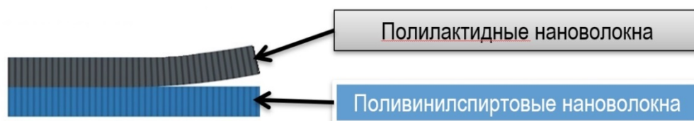
Рисунок 5.5 – Структура двухслойного нановолокнистого материала с различным профилем растворения
