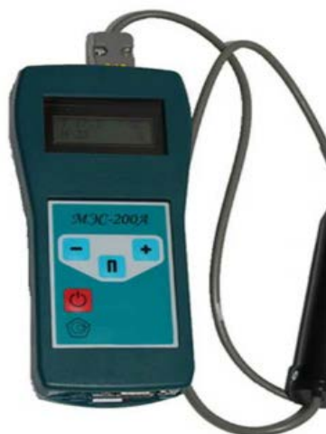
Рисунок 5.1 – Внешний вид метеометра «МЭС-200 А» со сменными щупами
