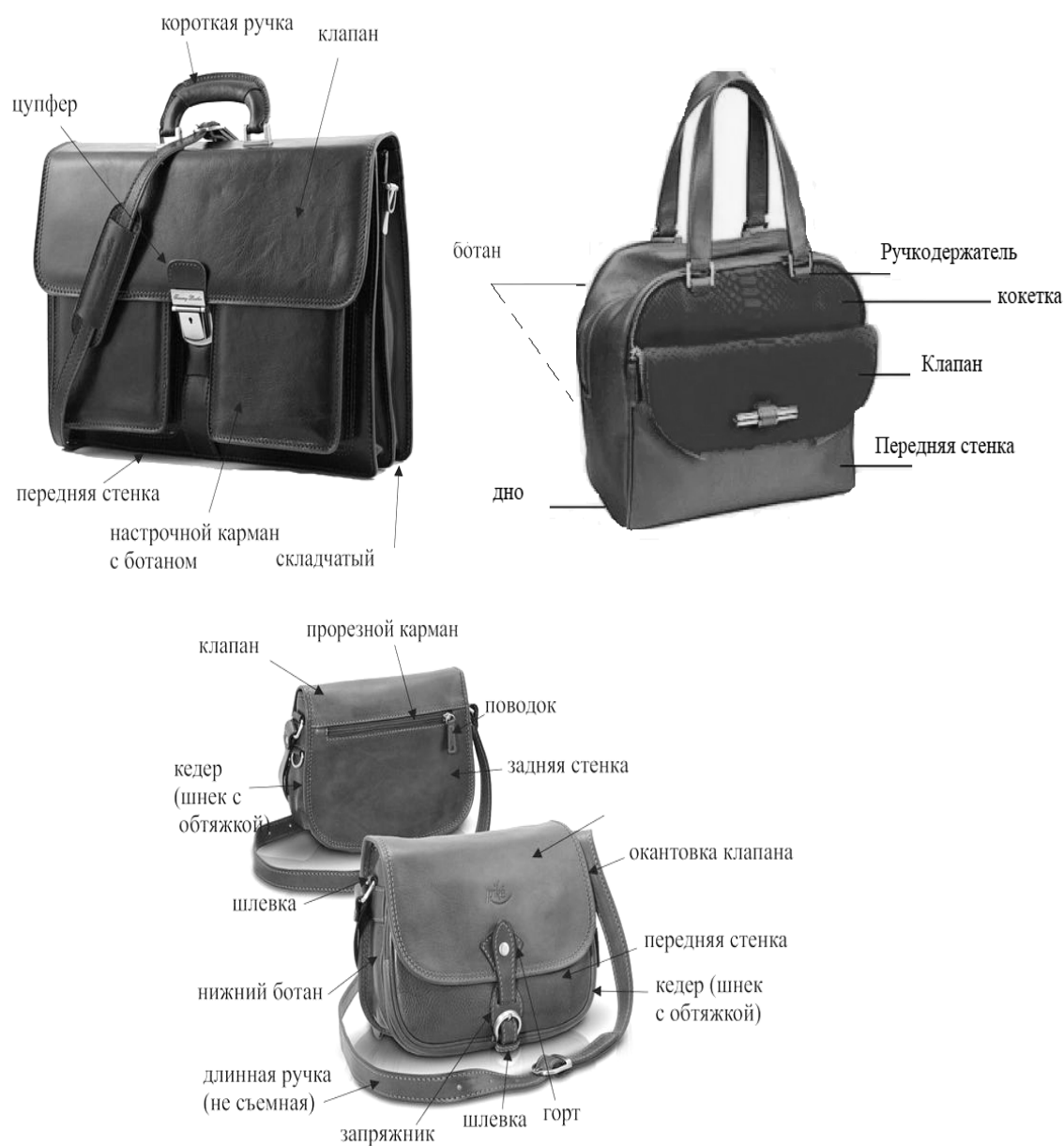
Рисунок 13.2 – Основные детали кожгалантерейных изделий на примере женских сумок и мужского портфеля
