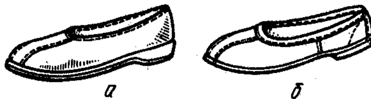
Рисунок 9.8 – Конструкции заготовок чувак: а – с полукруговыми союзками; б – с полусоюзками и отрезными задинками
