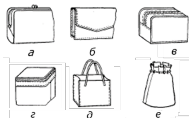
Рисунок 13.4 – Способы закрывания сумок: а – на рамочный замок; б – на клапан; в, г – на застежку-молнию; д, е – открытые
