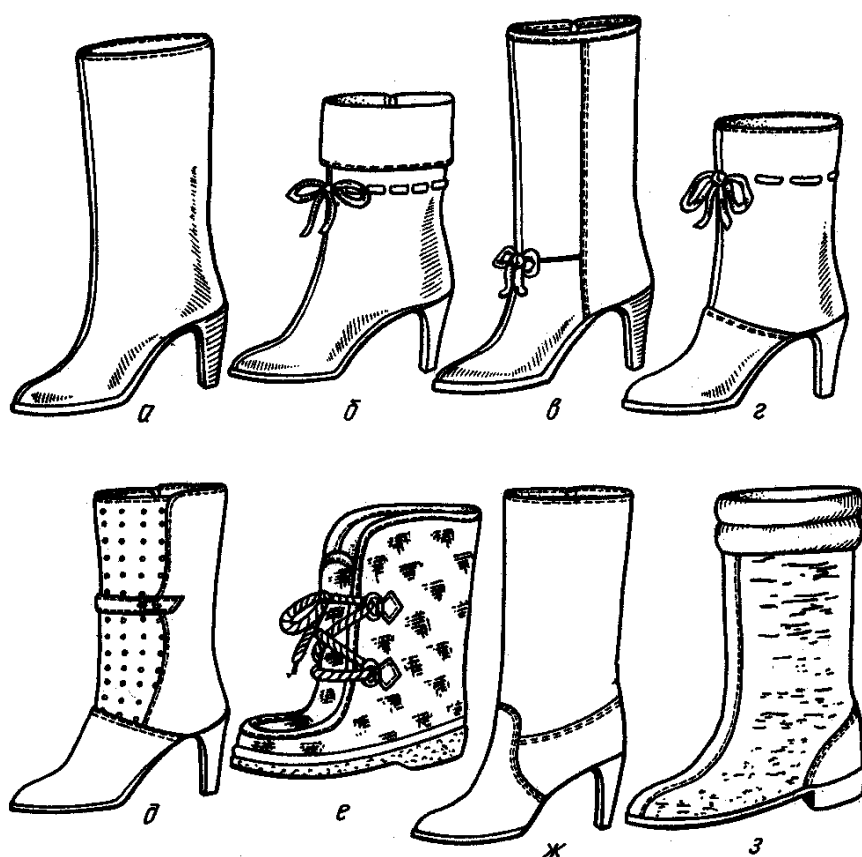
Рисунок 9.3 – Конструкции заготовок сапожек и полусапожек: а – с составными голенищами из двух деталей – наружного и внутреннего голенищ; б – с составными голенищами из трех деталей – наружного голенища и внутреннего голенища, включающего союзковую и задинковую части; в – с составными голенищами из четырех деталей – двух союзковых и двух задинковых; г, д – с настрочными союзками; е – с овальной вставкой; ж – с отрезной задинкой; з – комбинированные – с голенищами из дублированных тканей, с отрезной задинкой и передним наружным ремнем из кожи
