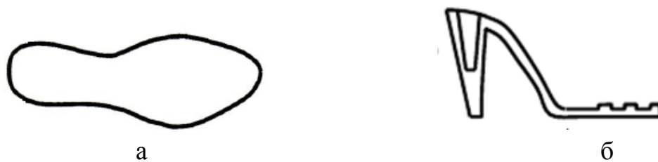
Рисунок 11.7 – Виды подошв: а – плоские, б – формованные
