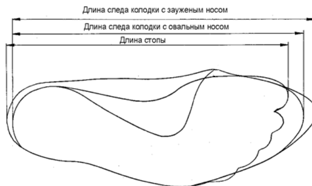
Рисунок 10.2 – Зависимость длины следа колодки от формы её носочной части
