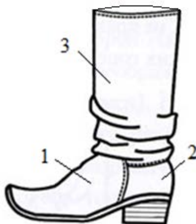
Рисунок 11.4 – Наружные детали заготовки сапога: 1 – союзка; 2 – задинка; 3 – голенище
