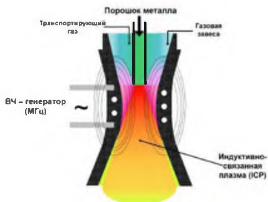
Рисунок 1 – Схема высокочастотного ВЧ-плазмотрона
