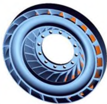
Рисунок 1 – Колесо гидротрансформатора являющееся частью КПП Allison
