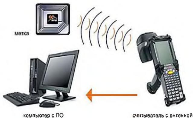
Рисунок 1 – Схема RFID-системы
