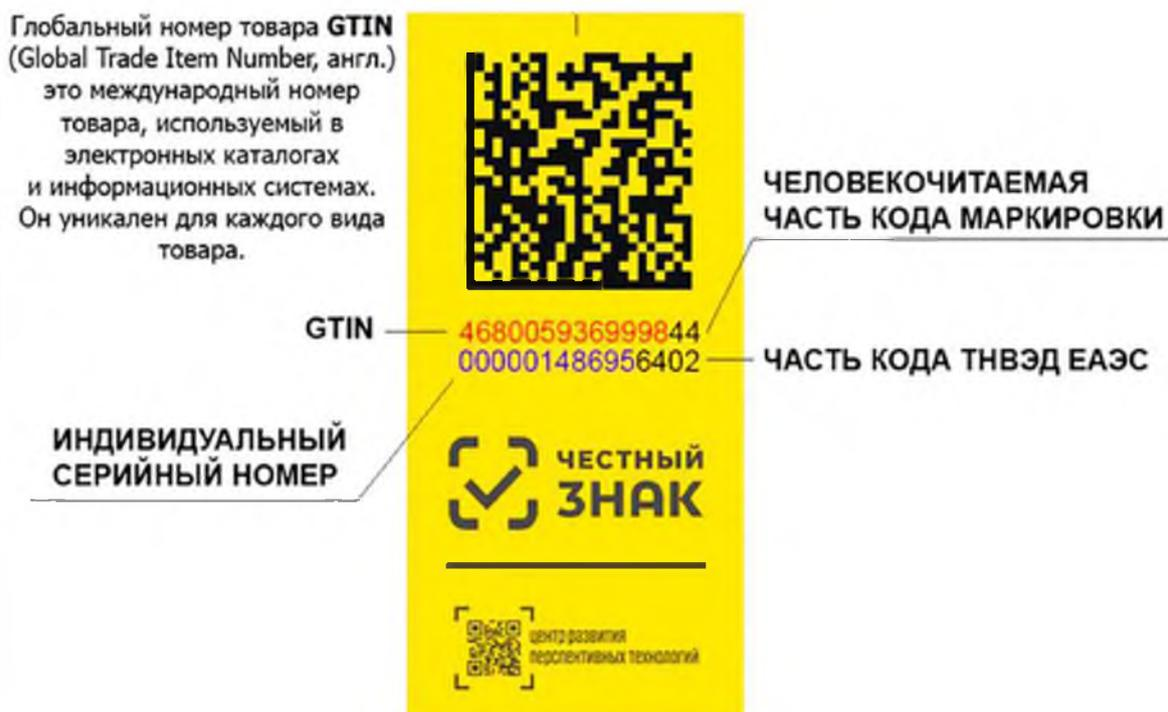
Рисунок 2 – Структура двумерного штрихкода Data Matrix
