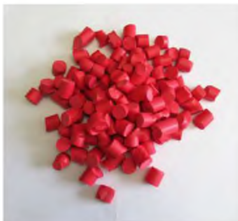
Рисунок 3 – Дробленые отходы литниковой системы ЭВА
