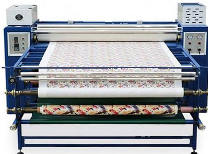
Рисунок 4 – Термопресс для широкоформатной печати на текстильных материалах
