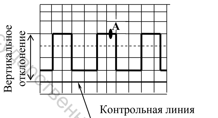
Рисунок 5.8 – Прямоугольная форма импульсов на экране осциллографа
