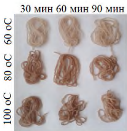
Рисунок 5 – Результат окрашивания шерстяной пряжи при разных режимах экстрагирования Figure 5 – The result of dyeing wool yarn under different extraction conditions
