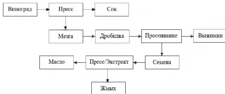
Рисунок 1 – Этапы переработки винограда и его отходов Figure 1 – Stages of processing grapes and their waste
