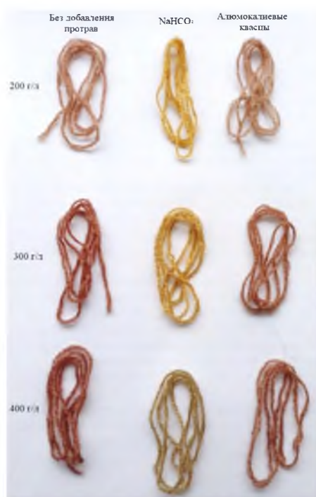
Рисунок 7 – Результат окрашивания шерстяной пряжи при разной концентрации виноградных выжимок в растворе
