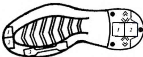
Рисунок 2 – Места вырубki образцов по ГОСТ 7926-75:
