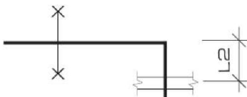
Рисунок 6.5 – Вариант установки неподвижных опор при Г-образной форме компенсации.
