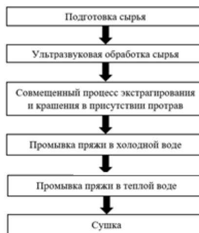
**Рис. 1. Энергоэффективная технология крашения шерстяной пряжи**
