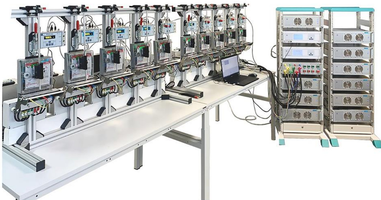
Рисунок 3.5 – Установка поверочная полуавтоматическая универсальная УППУ-МЭ21 для калибровки и поверки счетчиков электроэнергии
