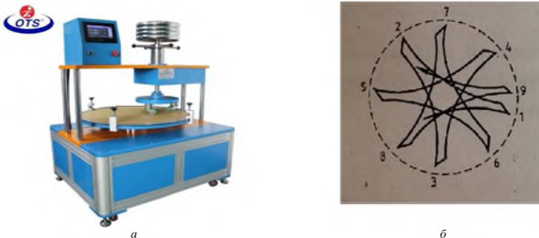
Рисунок 3 – Испытательное устройство OTS-425: а – внешний вид устройства; б – траектория движения колесиков
