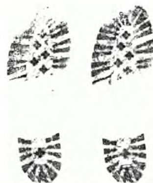
Рисунок 5 – Отпечатки ходовой поверхности подошв носочков массой 60 кг и 77 кг
