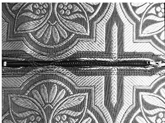
Рисунок 4 – Соединение текстильного материала при помощи молнии
