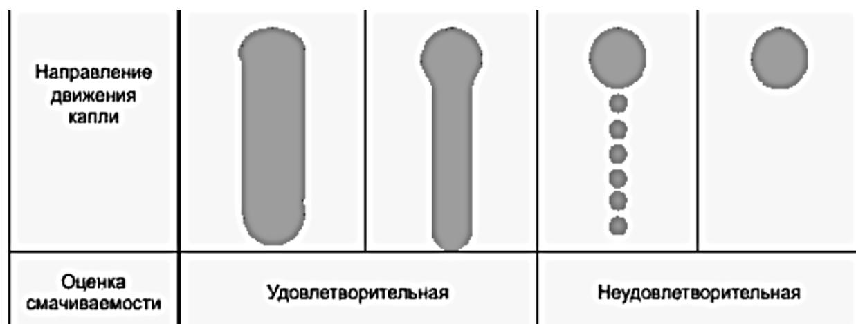
Рисунок 5.2 – Форма следа движения капли на поверхности фольги
