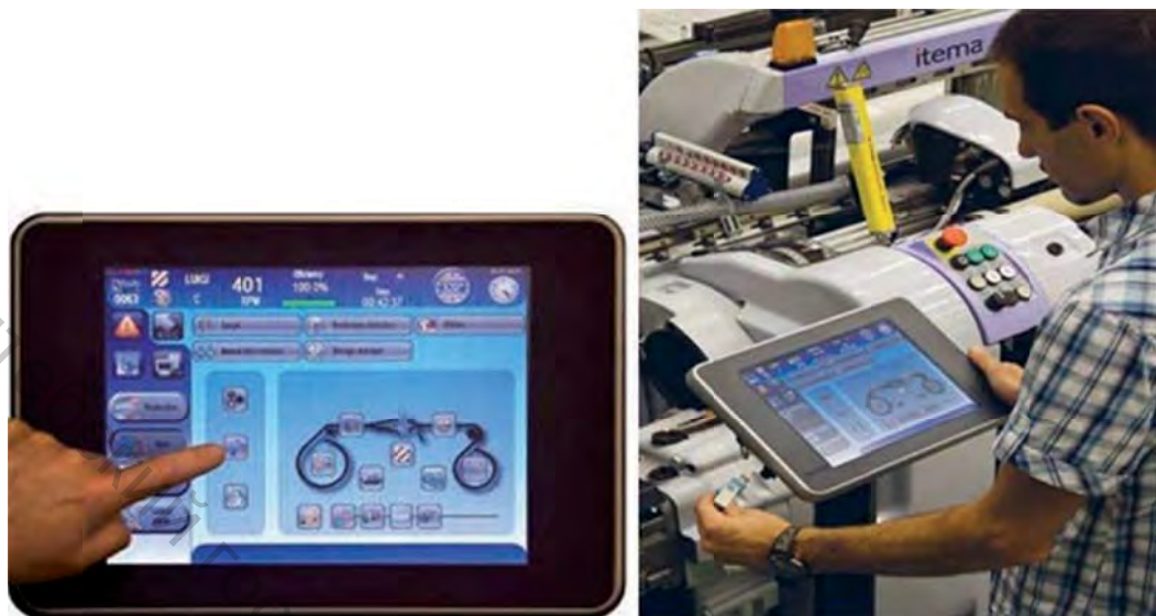
Рисунок 1 – Управление станком сенсорным дисплеем и перенос настроек станка при помощи Memory Stick USB
