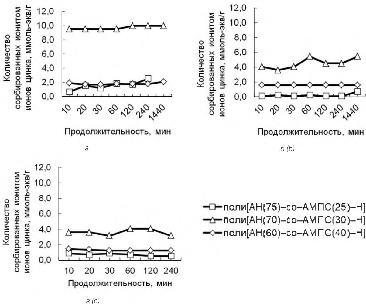
Рисунок 4 – Динамика изменения количества сорбированных ионов  $Zn^{2+}$  материалами на основе поли[АН-со-АМПС] из 0,1 н раствора  $ZnSO_4$  при первом (а), втором (б) и третьем (в) погружении
