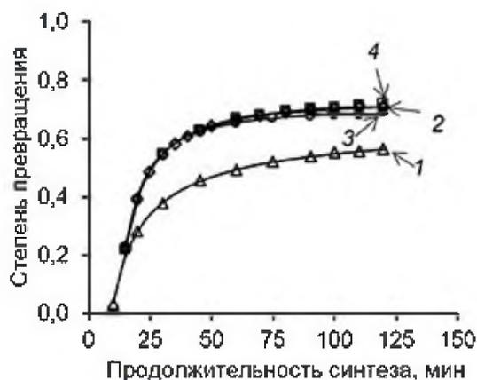
Рисунок 1 – Динамика синтеза поли[АН-со-АМПС] при 75 °С в ДМСО при содержании АМПС в исходной мономерной смеси, % (от массы мономеров):
