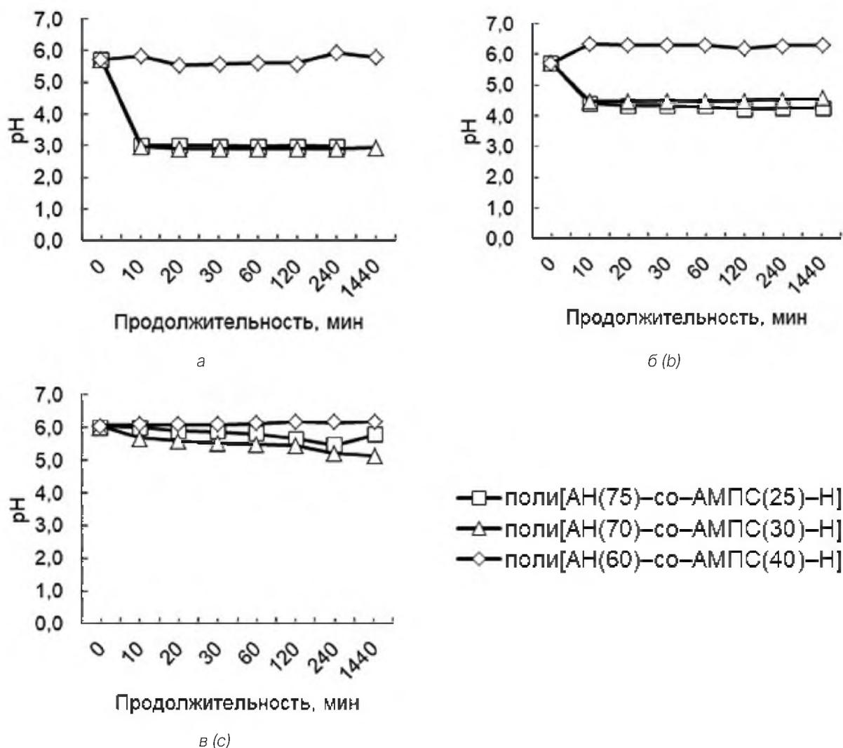
Рисунок 5 – Динамика изменения pH раствора в ходе эксперимента по изучению сорбции ионов  $Zn^{2+}$  материалами на основе поли[АН–со–АМПС] из 0,1 N раствора  $ZnSO_4$  при первом (а), втором (б) и третьем (в) погружении
