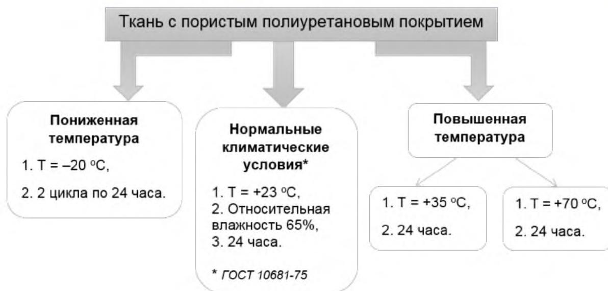
Рисунок 1 – Схема подготовки образцов
