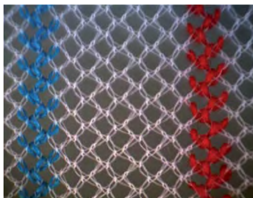
Рисунок 4 – Изображение лицевой стороны одинарного основовязаного трикотажа филейного переплетения
