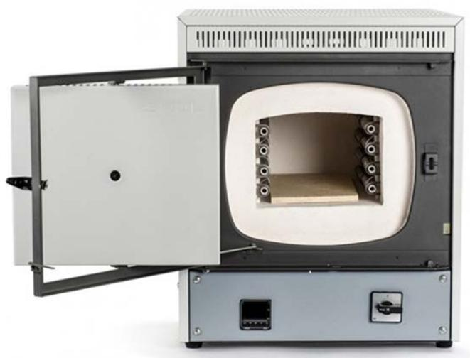
Рисунок 1.1 – Общий вид лабораторной печи SNOL 6,7/1300
