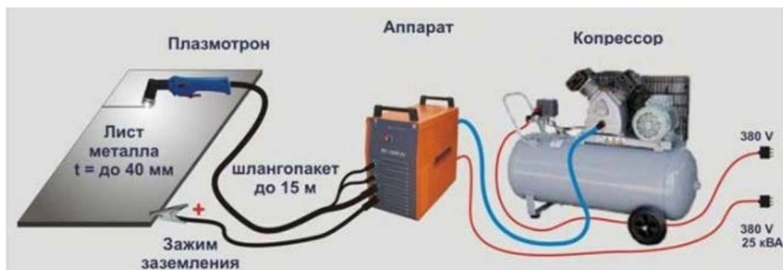
Рисунок 3.4 – Схема подключения аппаратов для организации плазменной резки
