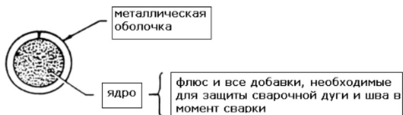
Рисунок 2.5 – Конструкция порошковой сварочной проволоки
