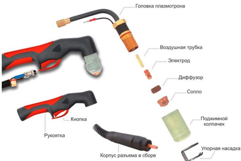
Рисунок 3.3 – Устройство плазмотрона – аппарата воздушно-дуговой резки
