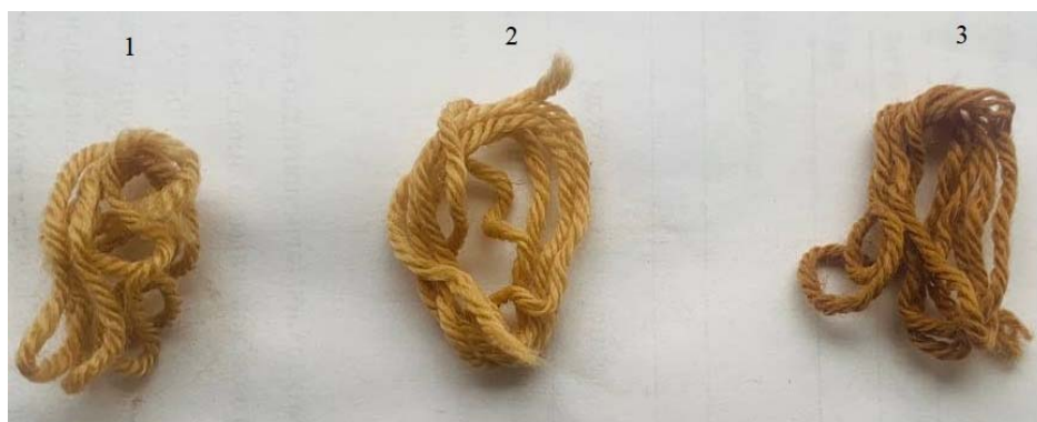
Рис. 2. Результат окрашивания шерстяной пряжи: 1 – с добавлением ПАВ; 2 – с добавлением глицерина и HCl; 3 – с добавлением винной кислоты
