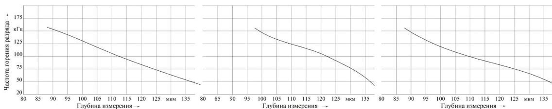
Рисунок 1 – Глубина «активного слоя» образцов после обработки тлеющим разрядом при различных частотах течения тока: а – сталь 4Х4ВМФС; б – сталь Р6М5; в – сталь Х12МФ
