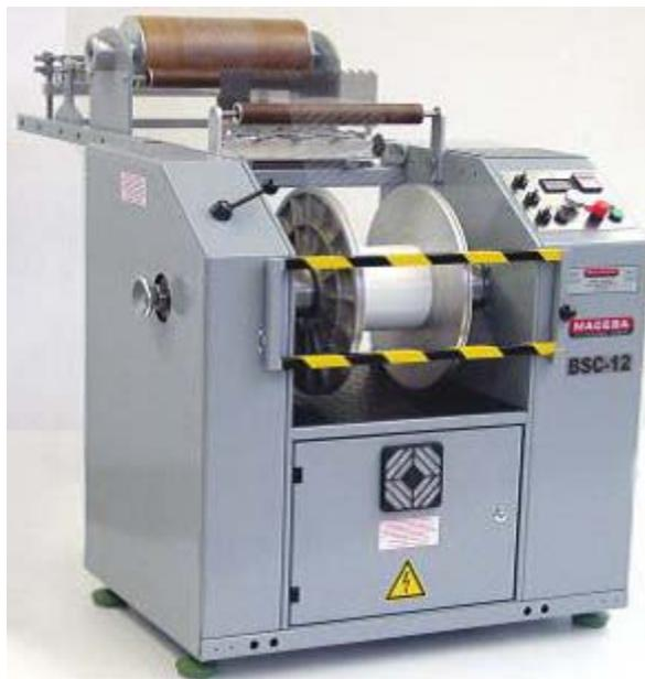
Рисунок 2.84 – Секционная сновальная машина BSC 12
