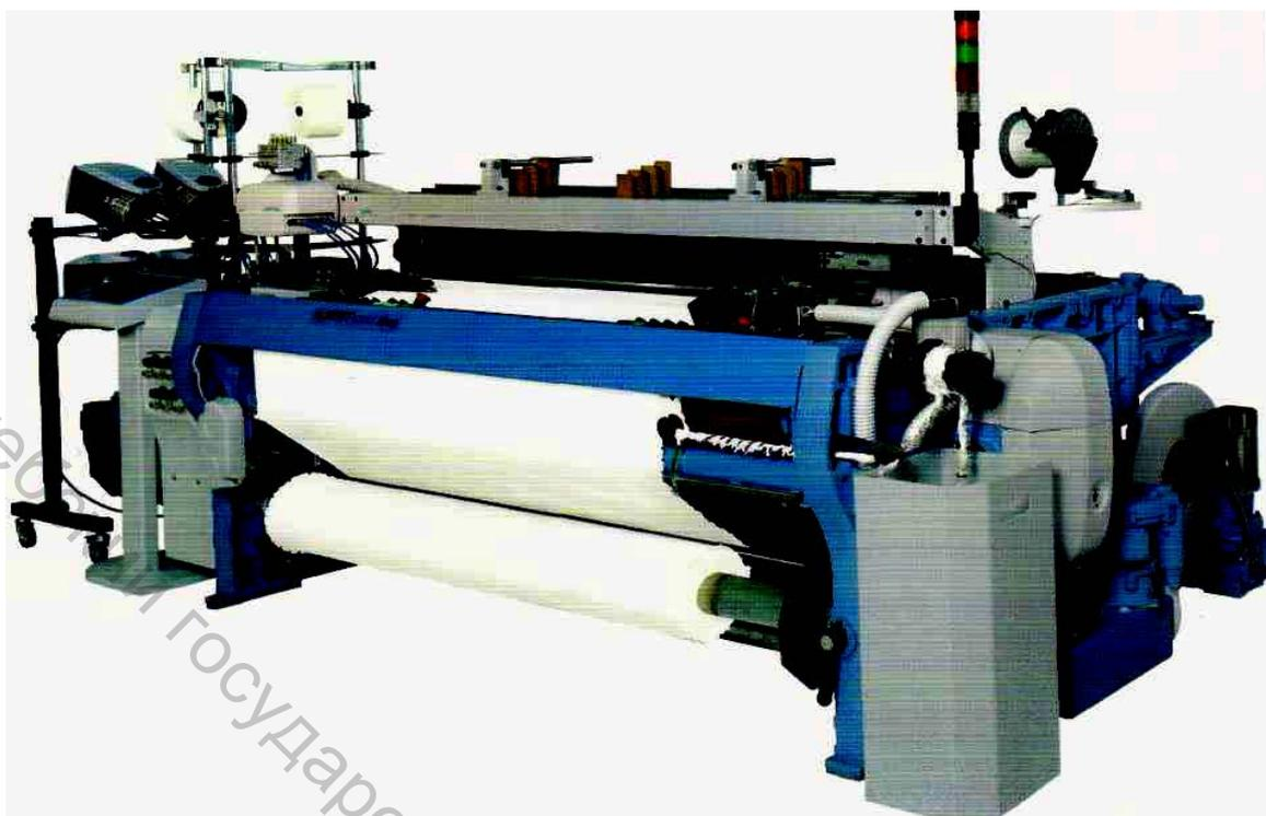
Рисунок 5.50 – Пневматический ткацкий станок JS900
