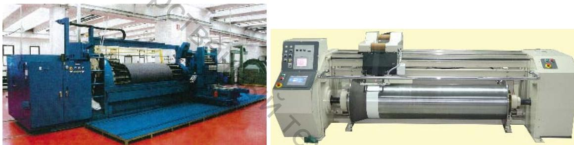
Рисунок 2.41 – Полуавтоматическая (слева) ленточная сновальная машина и машина NSW-5 (справа)
