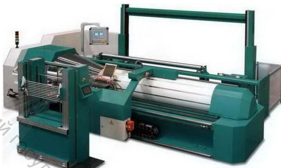
Рисунок 2.5 – Сновальная ленточная машина «Nov-O-Matic»
