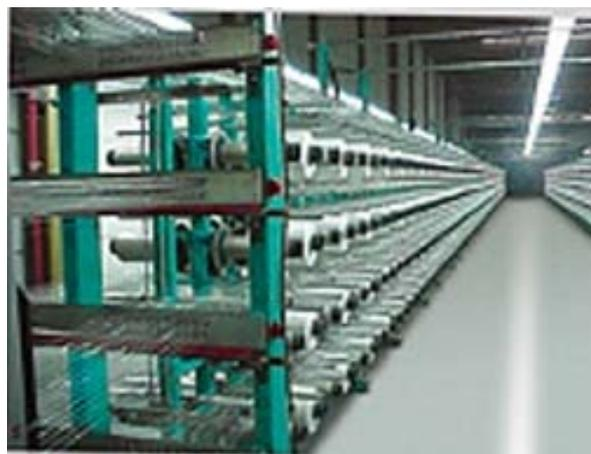
Рисунок 2.37 – Шпулярник с принудительным раскручиванием
