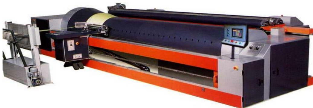
Рисунок 2.68 – Ленточная сновальная машина Küçüker
