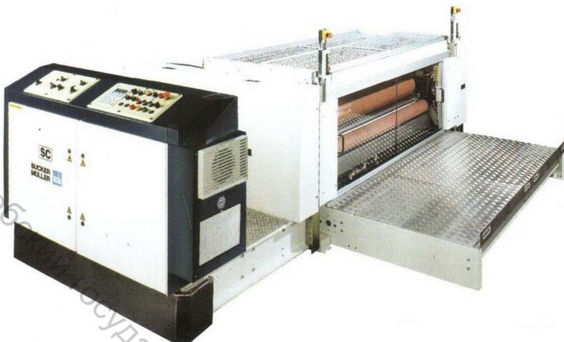
Рисунок 3.33 – Система шлихтования «WETSIZE» с предварительным увлажнением основы
