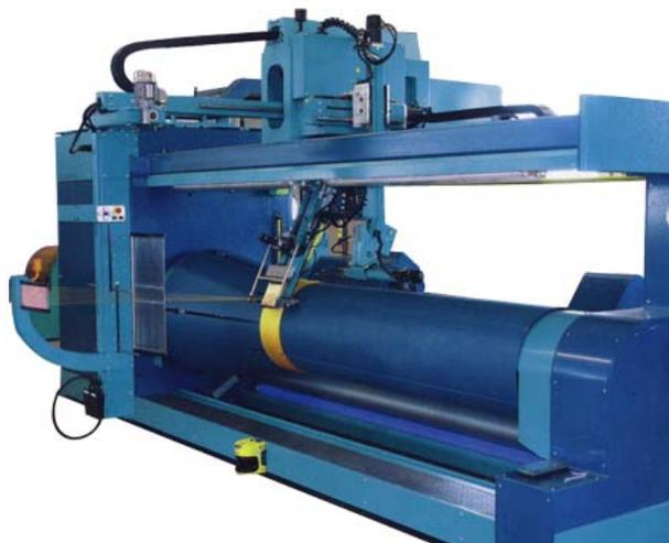
Рисунок 2.55 – Внешний вид машины MB 3 «Robowarp»
