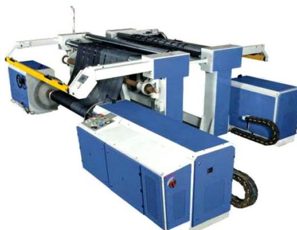
Рисунок 2.54 – Перегонная машина фирмы «Prashant Gamatex»
