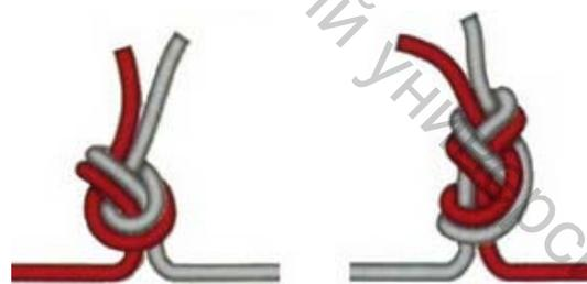
Рисунок 4.15 – Обычный (справа) или двойной узел для связывания основы (слева)
