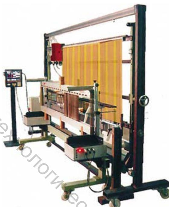
Рисунок 4.5 – Автоматическая проборная машина РМ 6
