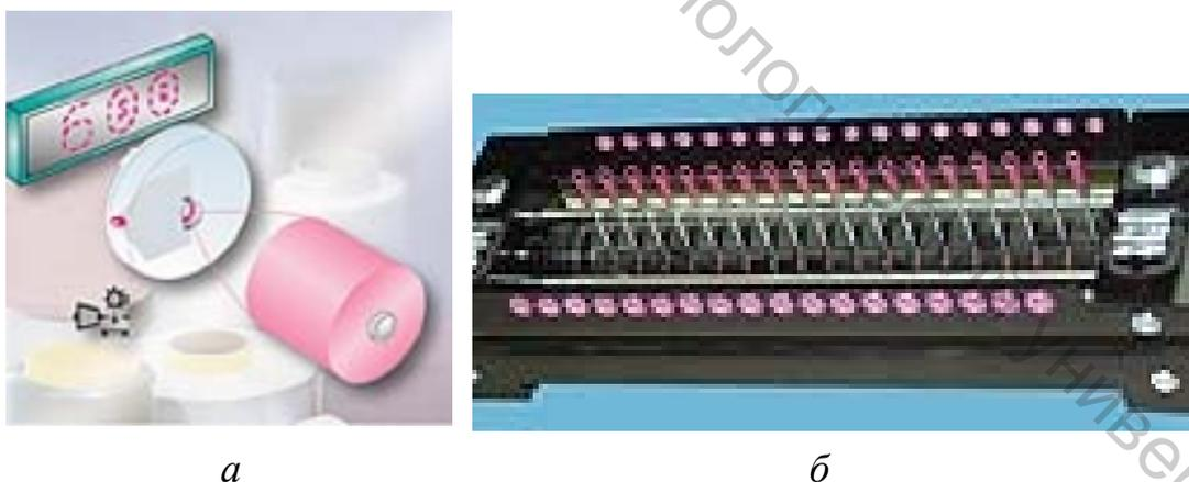
Рисунок 2.32 – Устройство автоматического останова (а) и нитенаправители и нитенатяжители (б)
