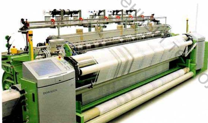
Рисунок 5.4 – Пневматический станок AWS 6/S 12 OC
