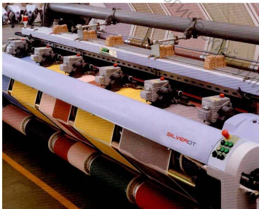
Рисунок 5.40 – Ткацкий станок SILVER DT
