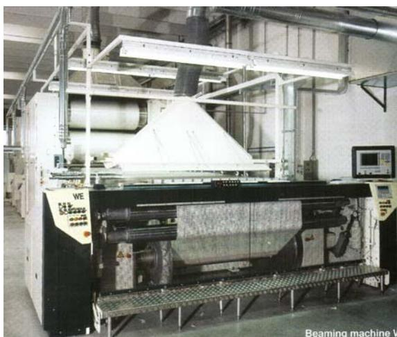
Рисунок 3.37 – Перегонная машина типа WE
