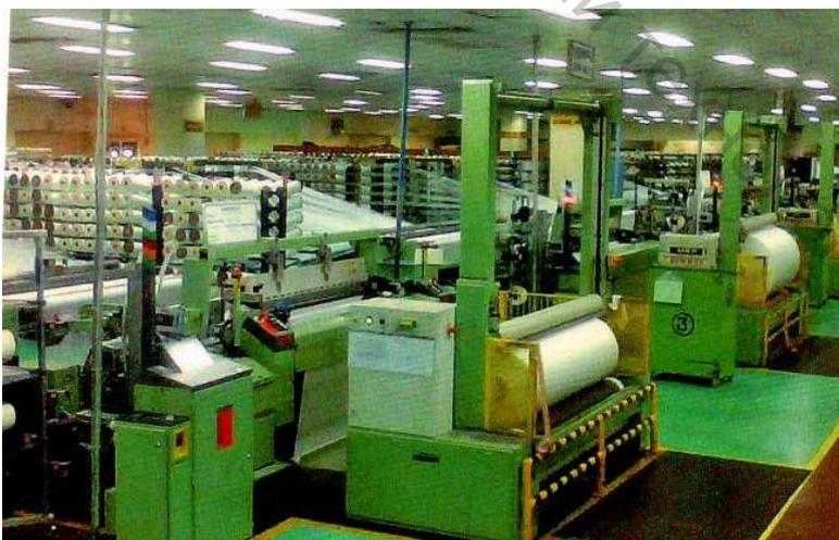
Рисунок 5.9 – Установка для производства шинного корда
