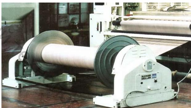
Рисунок 3.29 – Секционная система размотки ткацкого навоя
