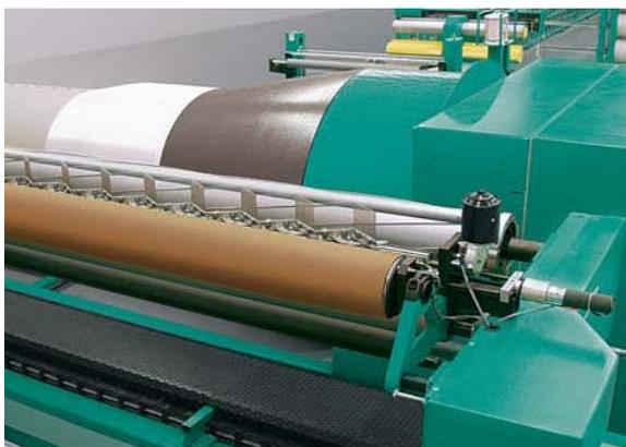
Рисунок 2.4 – Механизм прямого снования
