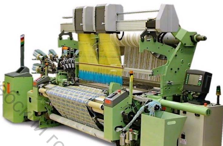
Рисунок 5.8 – Рапирный станок с системой EasyLeno® MultiPattern
