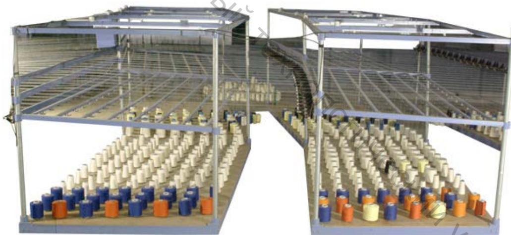
Рисунок 2.81 – Горизонтальный шпулярник модели RI 205
