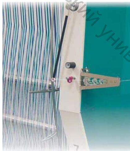
Рисунок 2.11 – Модуль передачи пряжи
