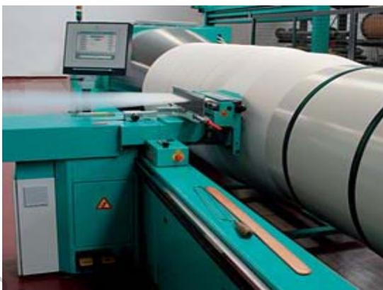
Рисунок 2.3 – Механизм суппорта с лазерным устройством
