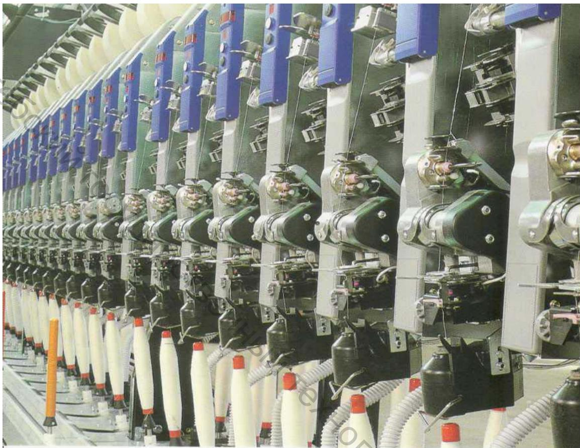
Рисунок 1.2 – Мотальный автомат Orion E
