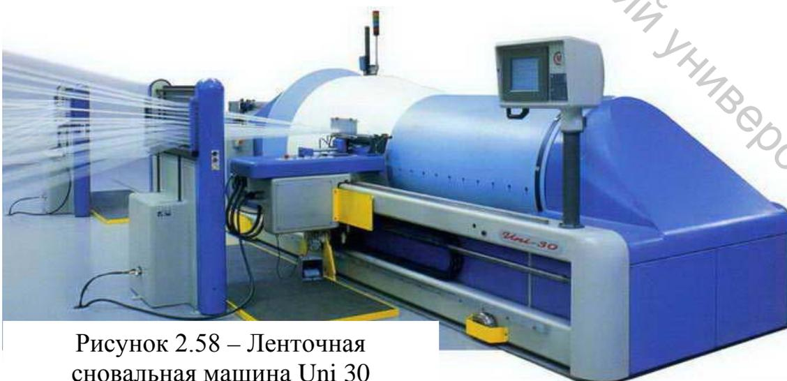
Рисунок 2.58 – Ленточная сновальная машина Uni 30
