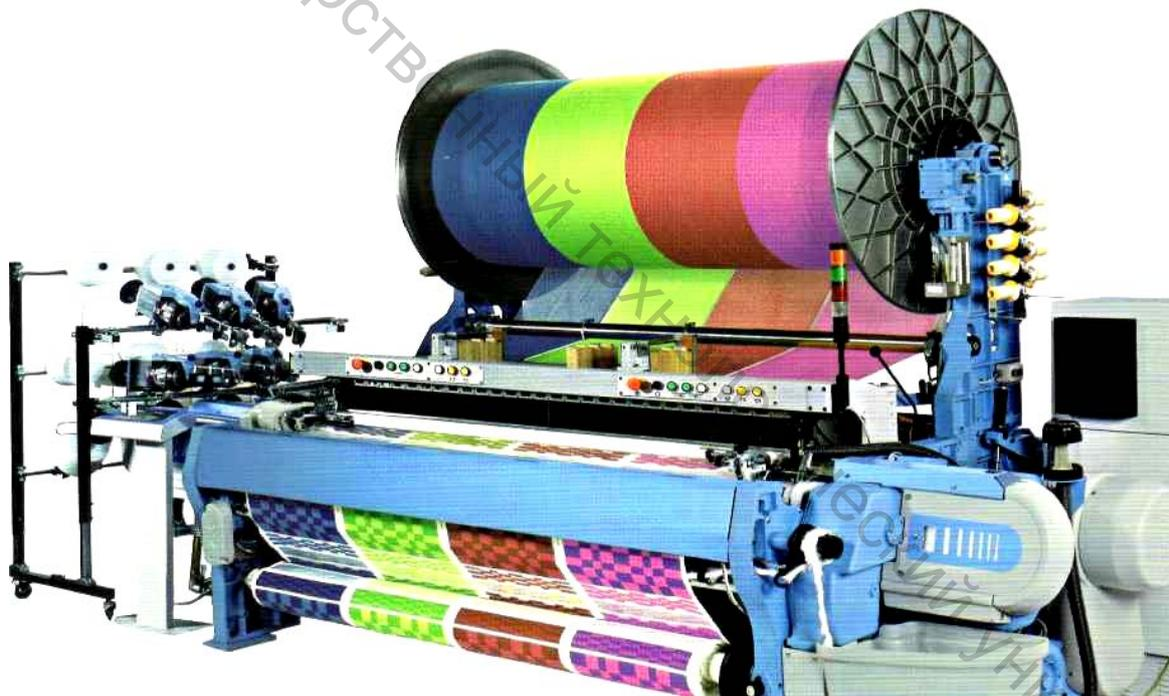
Рисунок 5.52 – Ткацкий станок GS920 F
