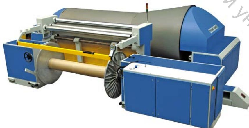
Рисунок 2.50 – Сновальная машина модели EP 1080/1100
