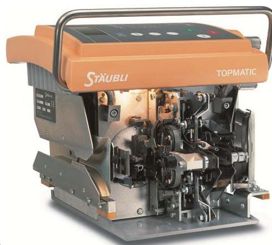
Рисунок 4.12 – Узловязальная машина TOPMATIC
