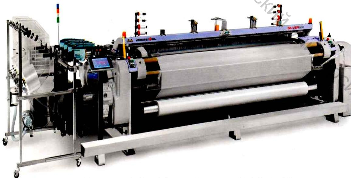
Рисунок 5.41 – Ткацкий станок SILVER 501
