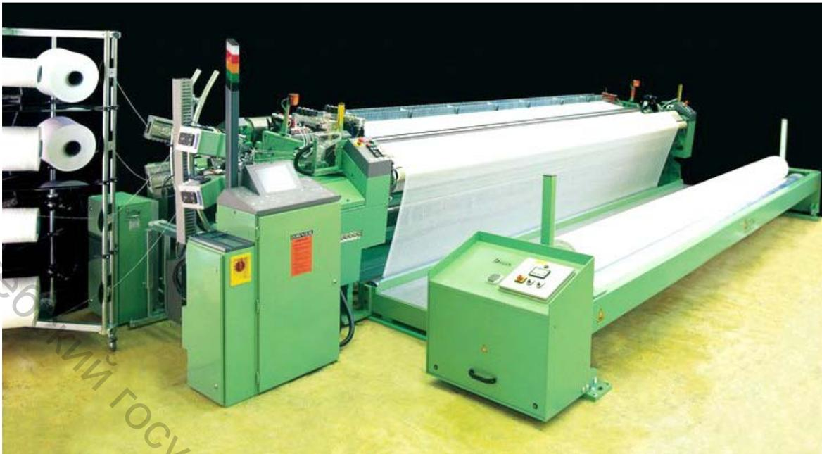
Рисунок 5.6 – Станок для производства ткани перевивочного переплетения
