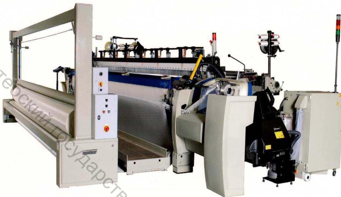
Рисунок 5.25 – Ткацкий станок типа OptiMax
