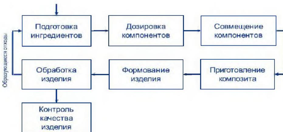
Рисунок 1 – Технологическая схема процесса получения материалов (пластин обуви)
