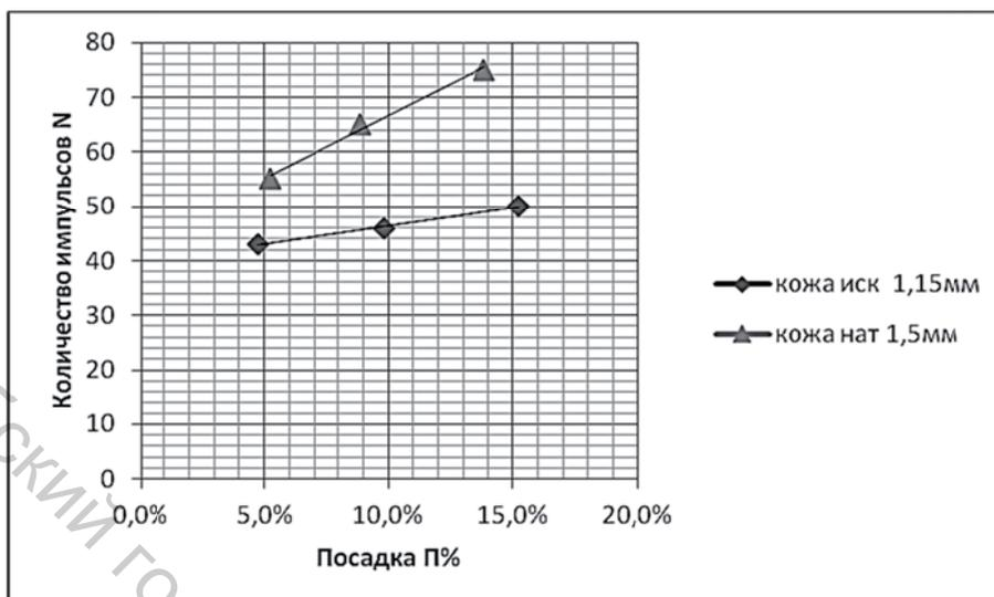
Рисунок 2 – График зависимости посадки от числа импульсов
