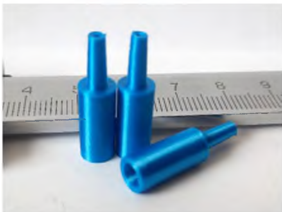
Рисунок 6 – Опытный образец переходной канюли для иглы Куликовского и шприца однократного применения типа «Луер»
