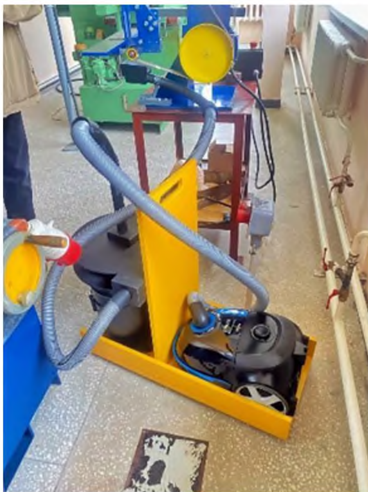
Рисунок 5 – Аспирационная установка для ленточношлифовального станка
