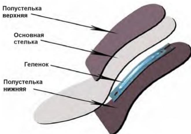
Рисунок 1 – Составные части стелечного узла
