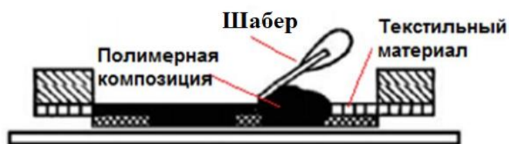
Рис. 2. Нанесение полиуретанового покрытия шаберным способом
