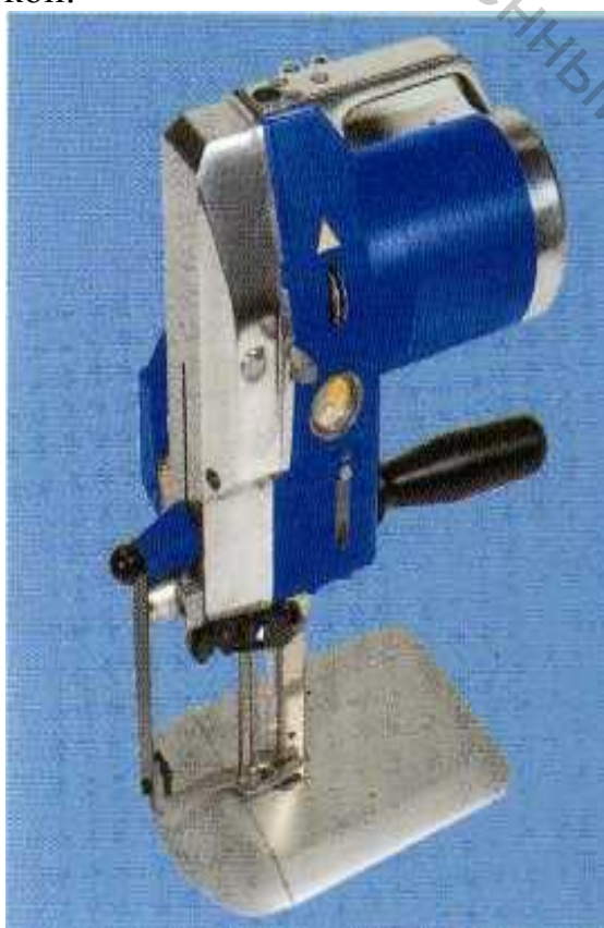
Рисунок 6.11 – Передвижная раскройная машина с возвратно-поступательным движением ножа (прямой нож)
