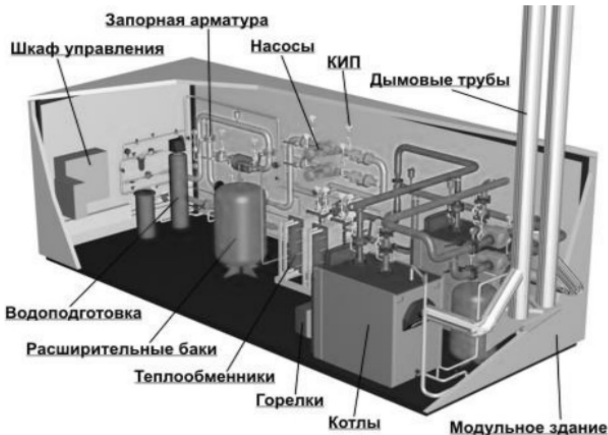
Рисунок 1 – Пример компоновки котельной
