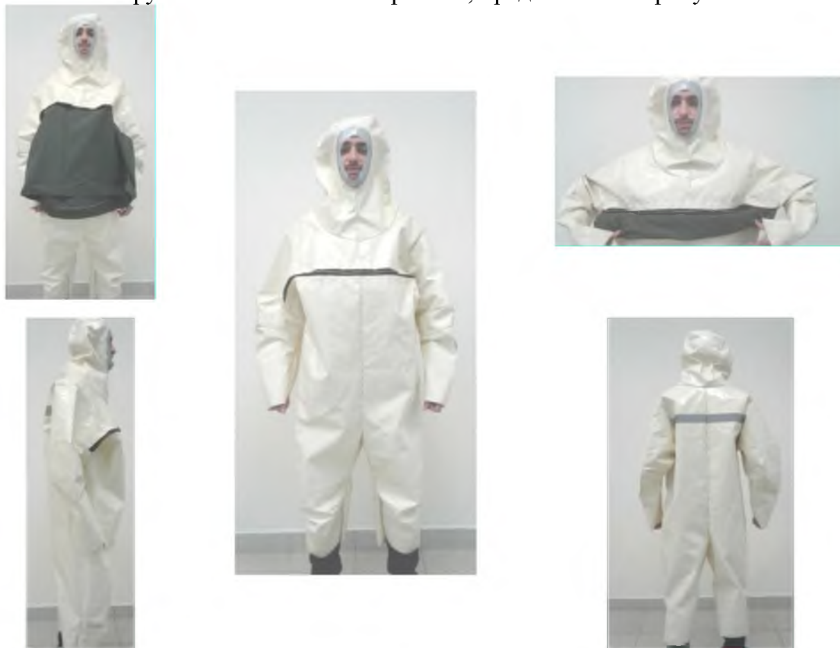
Рисунок 3 – Внешний вид первичного образца КИЗ с элементом положительной плавучести
